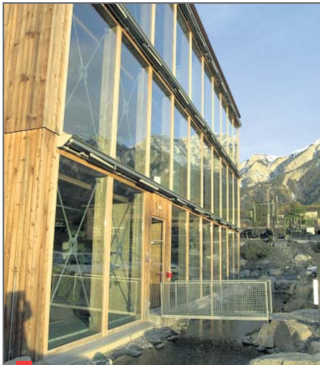
A Coire, cette maison passive abrite les bureaux et l'un des points de vente du marchand de matériaux de construction Josias Gasser Baumaterialien SA. Ce bâtiment consomme 5 à 8 kWh/m 2 a, soit 20 fois moins d'énergie qu'une maison traditionnelle.
